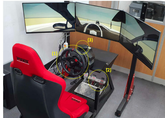
그림 1. 자율주행 시뮬레이터 (1) 운전대, (2) 가속 및 감속 페달, (3) 스피커폰
